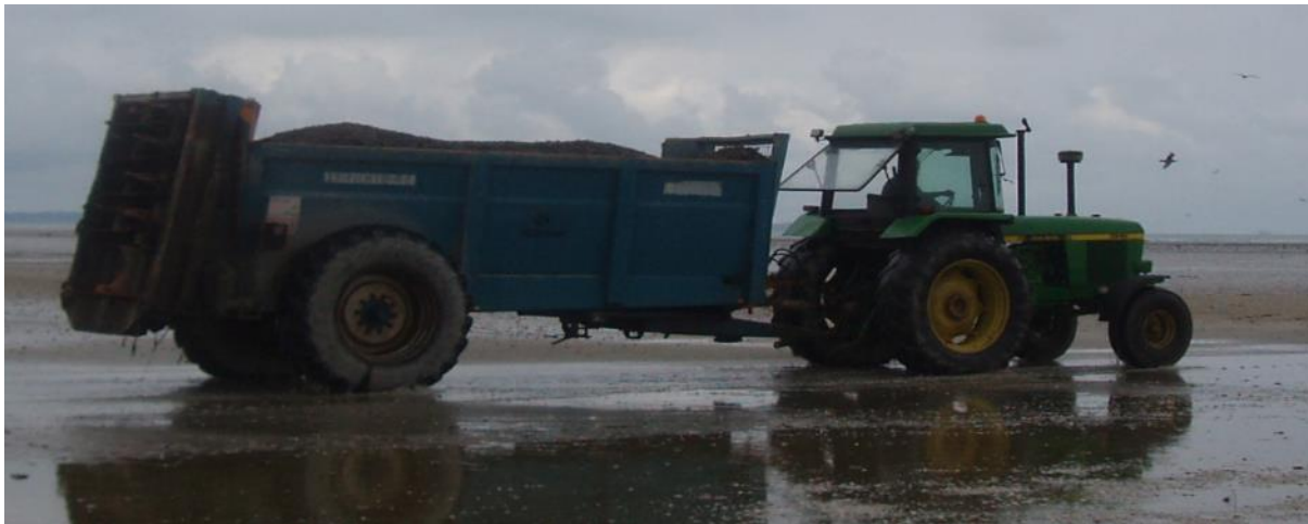
Figure 16 : Epandeur agricole prévu pour la pratique du dépôt de moules non commercialisables en Baie du Mont-Saint-Michel (Source : CRCBN)
