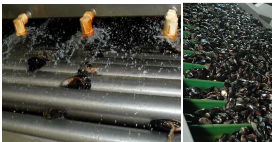
Figure 4 : Etapes de lavage, tri et calibrage des moules. (Source : CRCBN)
